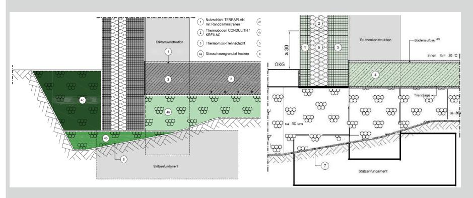
Gedämmte Sockelwandplatte auf Stützenfundament
