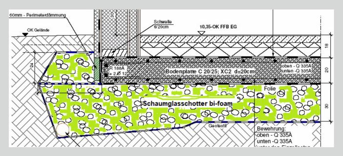
Im SGS Gesamtsystem, mit Einsparung an Erdaushub und Streifenfundamente werden weitere 20 t CO<sub>2</sub> bei einer Bodenplatte von 1000 m<sup>2</sup> vermieden.
